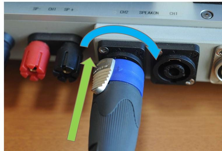
スピコンタの取り外しはロック解除レバーを手間に引きながら左に回してロックを解除してから引き抜く事で外せます。
