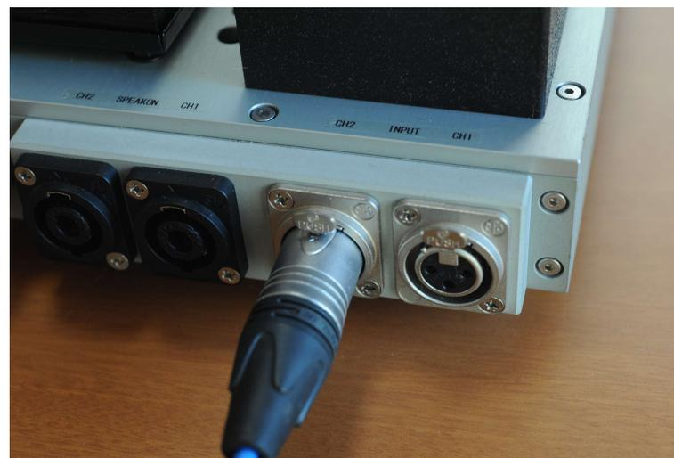
スピコンの取り付けはプラグの突起とレセプタクルの溝を合わせて押し込み右に回すとカチッとロックされます。
