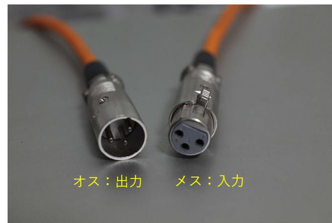
キャノンコネクタの取り付けは3本のピンの向きを合わせて押し込むだけでカチッとロックされます。
