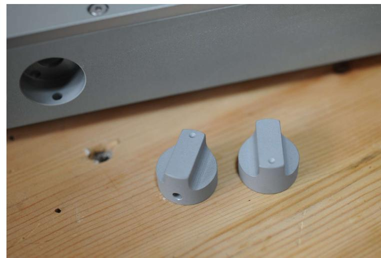
ツマミはアルミ丸棒を削り出して作成、手になじむ様にサンドブラスト加工を施してあります。
