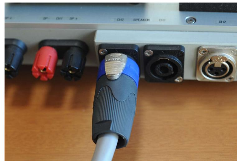
パソコンの取り付けはプラグの突起とレセプタクルの溝を合わせて押し込み右に回すとカチッとロックされます。
