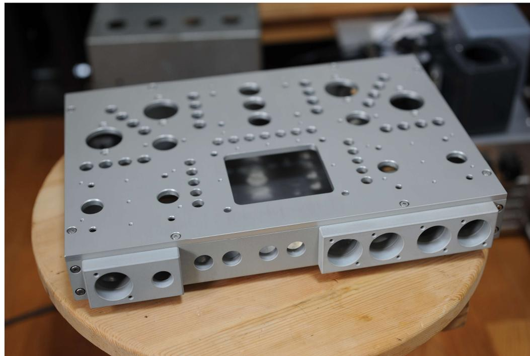
天板は5mm、側面は8mm、コネクタブラケットは10mmのアルミ材を切削加工で作成、側面のフレームはサンドブラスト加工の後にアルマイト処理をしていますので強度は抜群に高いです。
