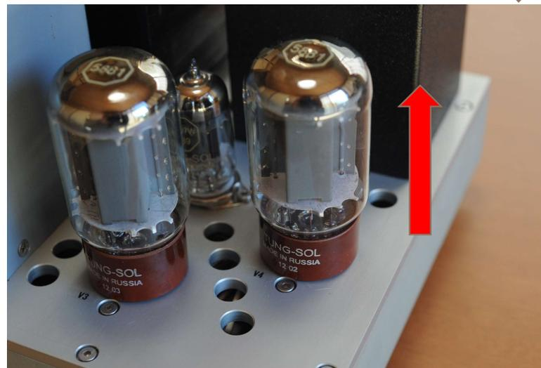
真空管を抜き差しする時に強くこじるとセンターピンが破損しますので注意が必要です。
