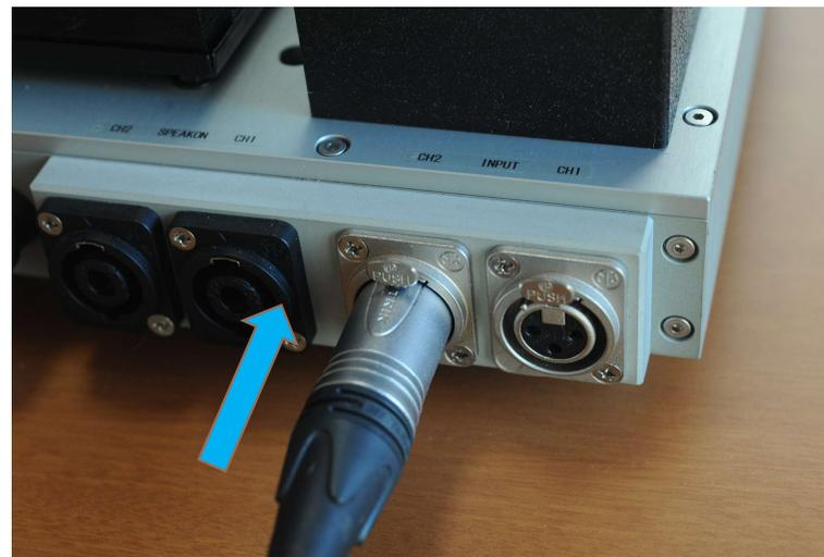
キャノンコネクタの取り外しはロック解除レバーを押しながら引き抜く事で外せます。
